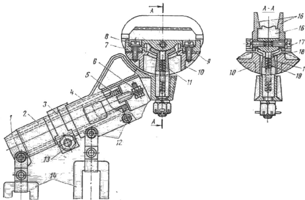
**Рис. 5.4** Головка токоприемника
