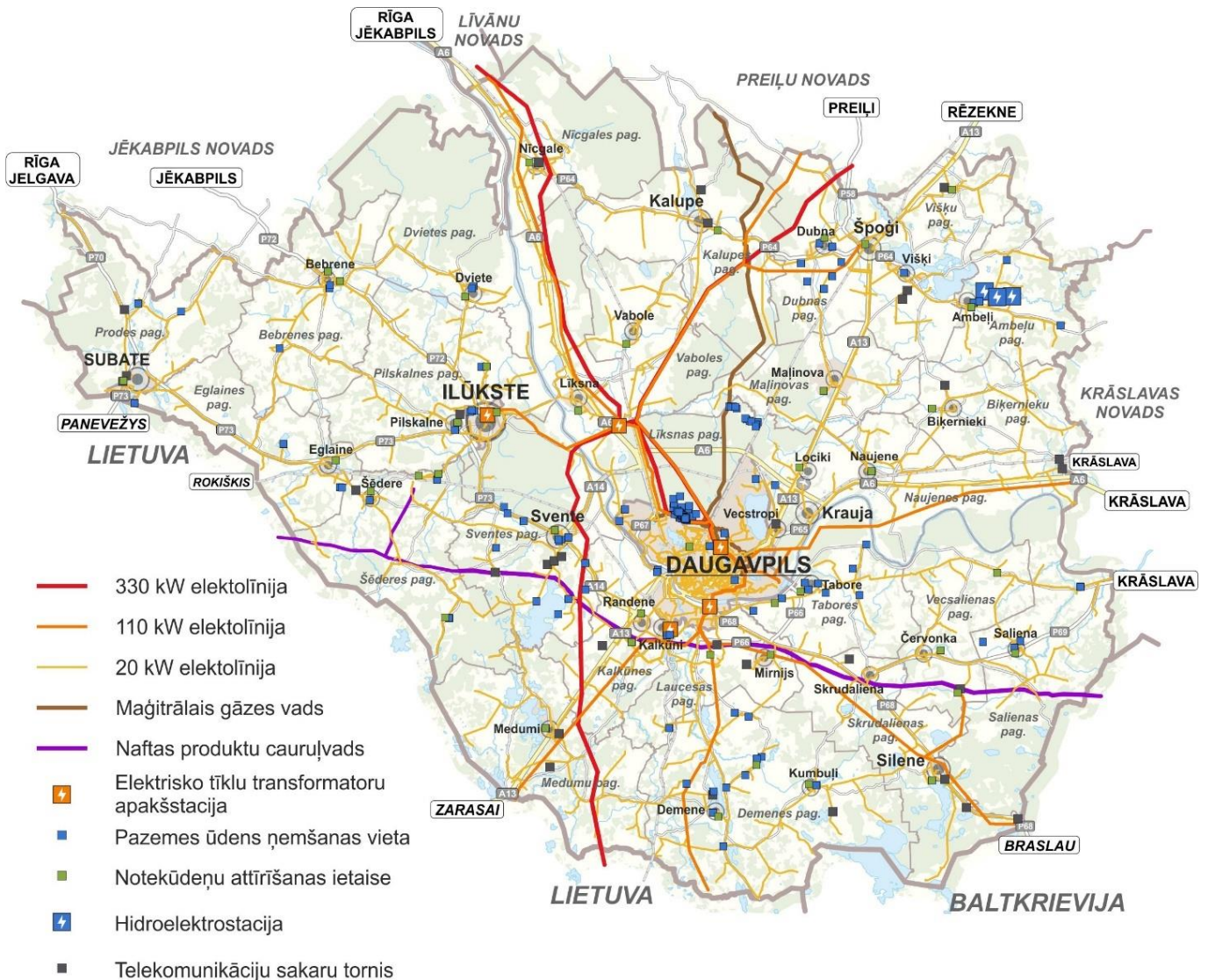
ATTĒLS 43. Inženiertehniskā infrastruktūra
