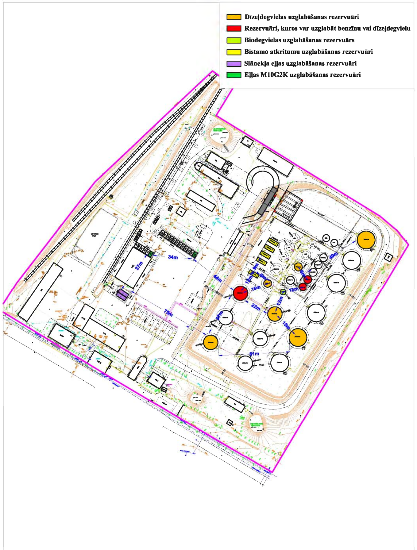
1.3.att. Rezervuāru novietojums un izmantošana Mērogs 1:2000
