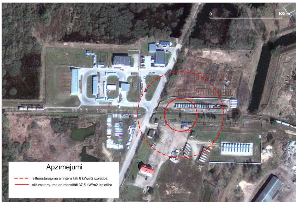
Att. 3.18. Siltumstarojuma iedarbības izplatība dīzeļdegvielas dzelzceļa cisternas izplūdes un aizdeģšanās gadījumā ( v=1\text{m/s} )
