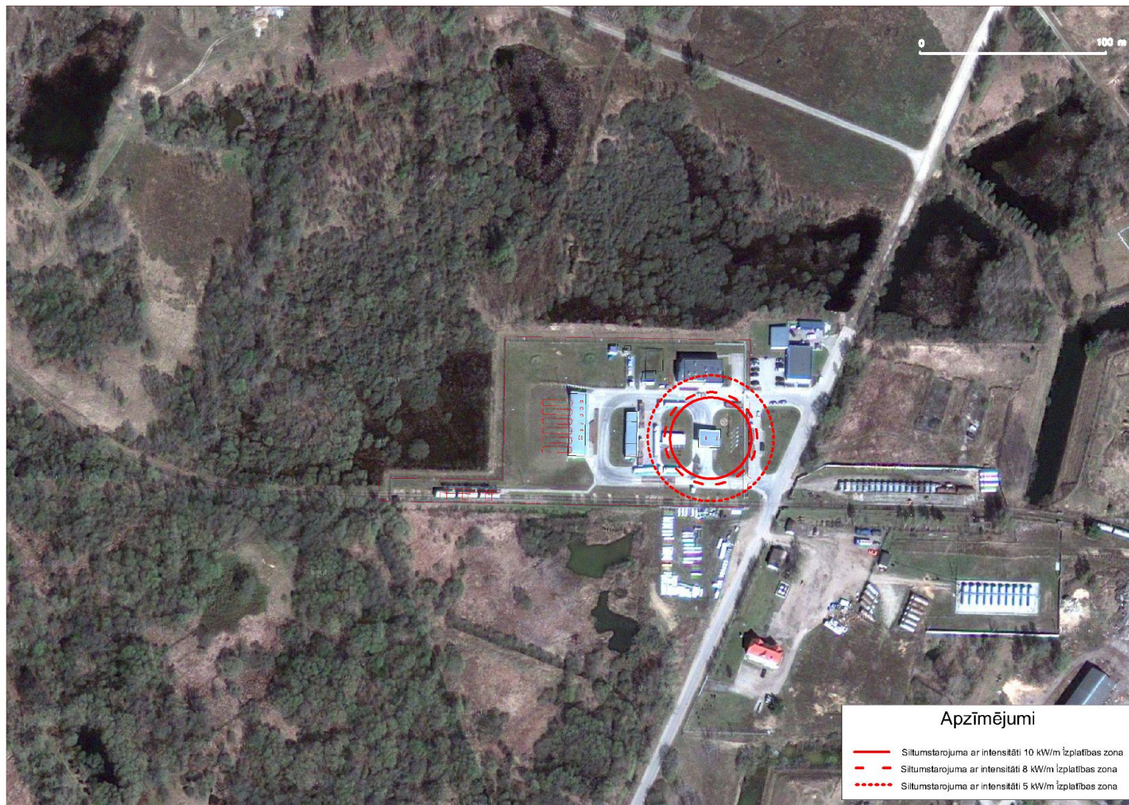
Att. 3.8. SNG strūklas ugunsgrēka radītā siltumstarojuma izplatība autocisternas uzpildes cauruļvada pārrāvuma gadījumā ( v = 5\text{ m/s} )
