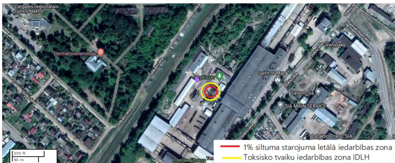
1. attēls. Acetilēna balona strūkļas ugunsgrēka radītā siltumstarojuma izplatības un toksisko tvaiku IDLH izplatības zona
