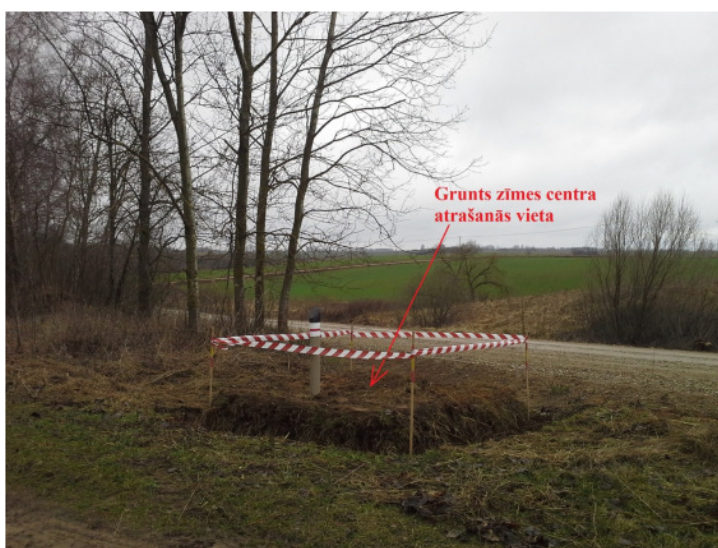
Att.S9.1. Ar stigmatiņiem un norobežojošo lentu atzīmēta valsts ģeodēziskā tīkla punkta (grunts zīmes) piemērs.
